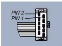
PIN 1 : non connecté / non connecté / bleu anode (+) / vert cathode (-) / rouge anode (+)
